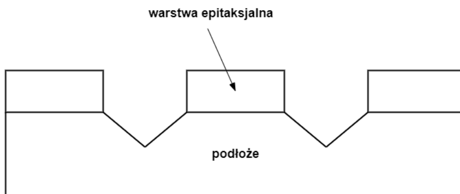
Rysunek 2.7. Selektwna epitaksja na przestrzennie strukturyzowanym podłożu (schemat ideowy)
