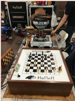
Robotyczna szachownica z głową EMYS
