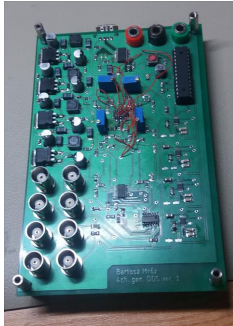
Gotowa, działająca płytką generatora DDS.
