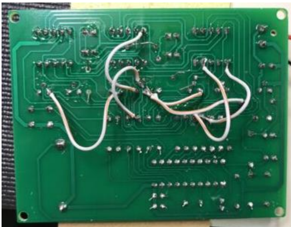
Rys. 4. Anglojęzyczni elektronicy nazywają ten sposób reperowania płytek „bodge wire”.
