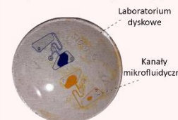
Rysunek 3. Lab-dysk szklany z mikrokanalami wypełnionymi roztworami barwników
